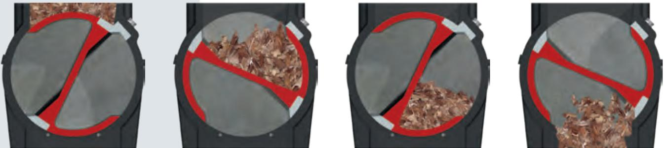
Die zwei großvolumigen Kammern (200 mm Rotordurchmesser) eignen sich hervorragend für die Aufnahme von Hackgut bis P31S (ehemals G50). Großer Widerstand wird automatisch erkannt. Die Zellradschleuse und Schnecke laufen rückwärts (je nach eingestellten Parametern mehrmals) bis ein Weitertransport möglich ist.
