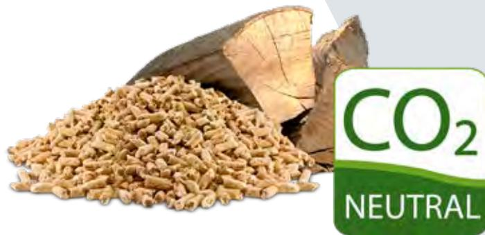
Holzpellets bestehen aus naturbelassenem Holz. Die in der Holzverarbeitenden Industrie als Nebenprodukt in großen Mengen anfallenden Hobel- und Sägespäne werden unbehandelt verdichtet und pelletiert. Durch die hohe Energiedichte und die einfache Liefer- und Lagermöglichkeit erweisen sich Pellets als der optimale Brennstoff für vollautomatische Heizanlagen. Die Lieferung der Pellets erfolgt mittels Tankwagen, von dem aus der Lagerraum direkt befüllt wird.
