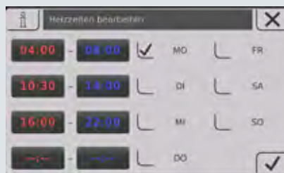
Abb. 2 Ansicht der Heizzeiten (individuell einstellbar)
